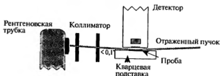
Рис. 20. Основные узлы рентгенофлуоресцентного спектрометра с ЭД. Система полного отражения.
